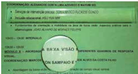
Lupa de apoio para ampliação para perto.
