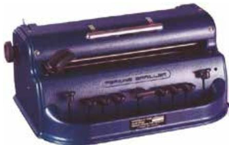
Máquina de datilografia braille, marca Perkins.
