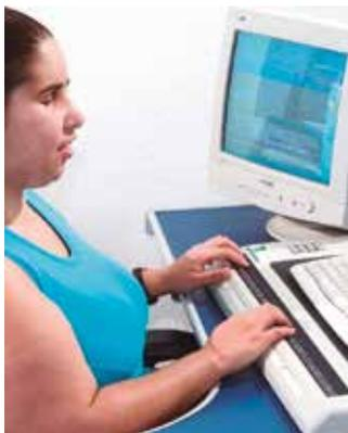
Revisora utilizando uma linha braille conectada ao computador.
